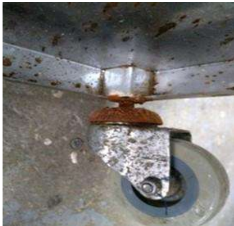
Reposición de llantas a carro de medicamentos de urgencias
